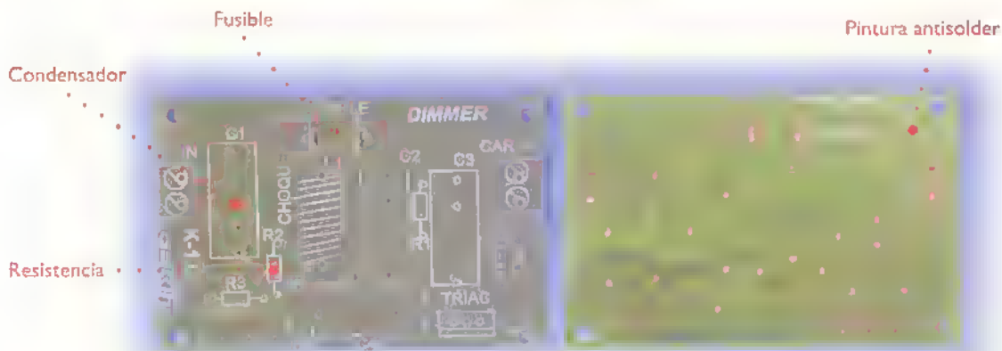
Figura 3.38. Dibujo de los componentes y pintura antisolder
